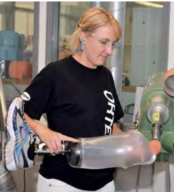
Fertigung eines Schafts zur Erstversorgung aus durchsichtigem, thermoplastisch verformbarem Kunststoff
